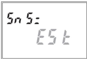
Scegliere tramite i tasti **"▲"** e **"▼"** **"Int"** se si vuole utilizzare la sonda interna oppure **"Est"** se si vuole utilizzare la sonda esterna (opzionale) e premere **"✓"** per confermare la scelta.
