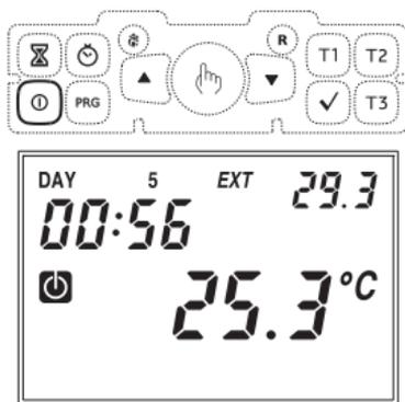
In funzionamento estivo invece la condizione di impianto spento esclude completamente il comando di refrigerazione. Per tornare al modo di funzionamento precedente allo spegnimento, premere nuovamente il tasto “
