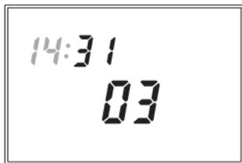
Una volta impostato il valore delle ore, sul campo **(22)** compare lampeggiante il valore dell'anno, sul campo **(15)** il valore del mese e sul campo **(16)** il valore del giorno.
